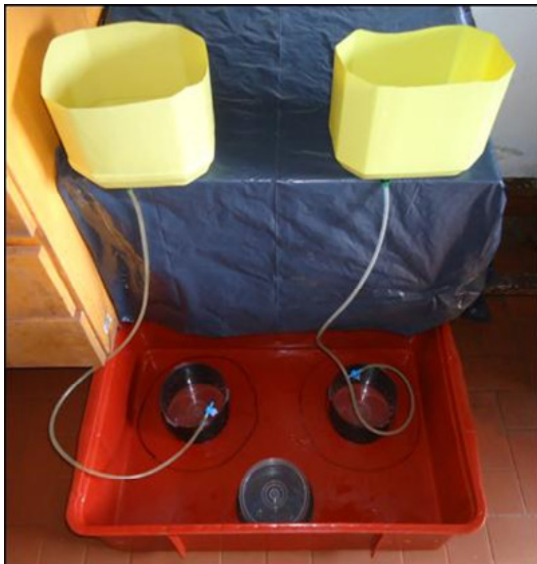
Fig. 4.2. Dispositivo utilizado en el diseño de experimentación 2: contenedor plástico común (color bordó) conteniendo los cilindros opacos con perforaciones de 2 mm 2 y los contenedores adicionales (color amarillo), colocados 1 m por encima de los cilindros, con mangueras con regulación propia conectadas a sus respectivos cilindros. Rodeando a cada cilindro se observa el círculo dibujado.
